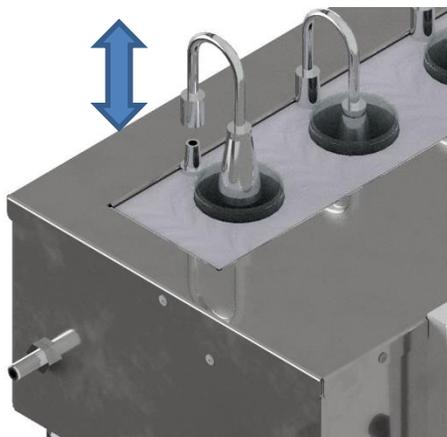
Se os poços não atingirem a temperatura estipulada, altere o valor no controlador de temperatura, desde que fique dentro da faixa de 160 °C a 165 °C . Siga as instruções da norma referente ao ensaio para mais detalhes na preparação e obtenção dos resultados.
