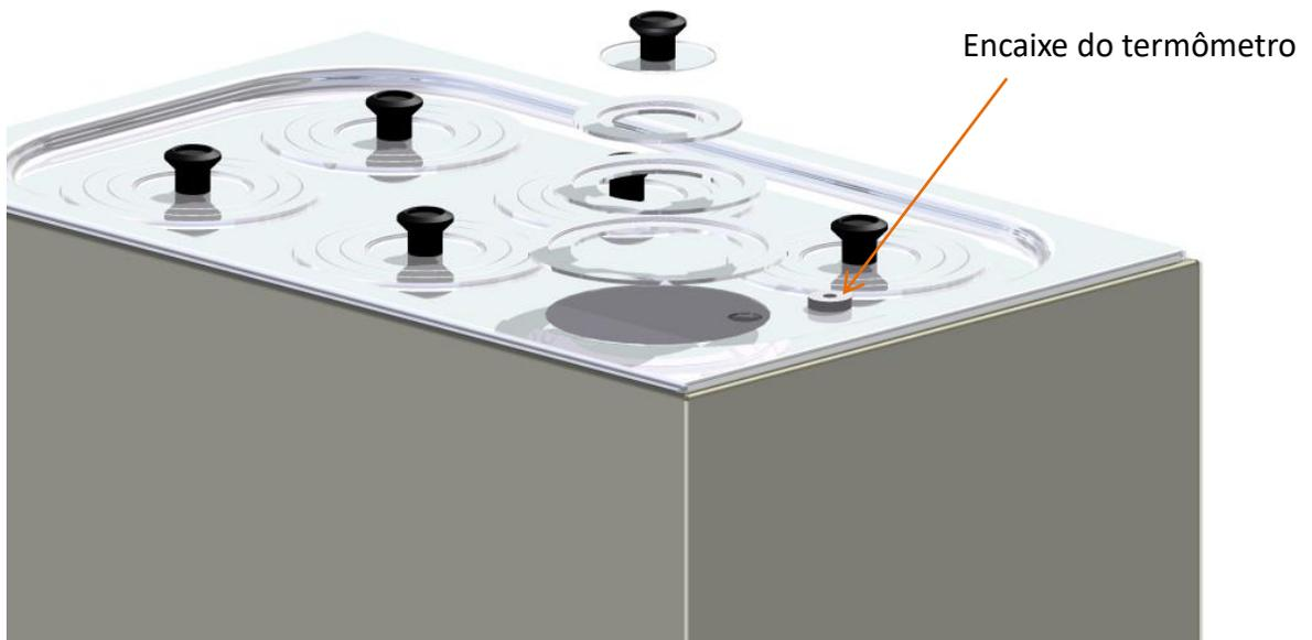
O encaixe do termômetro tem o diâmetro correspondente para termômetros ASTM.
