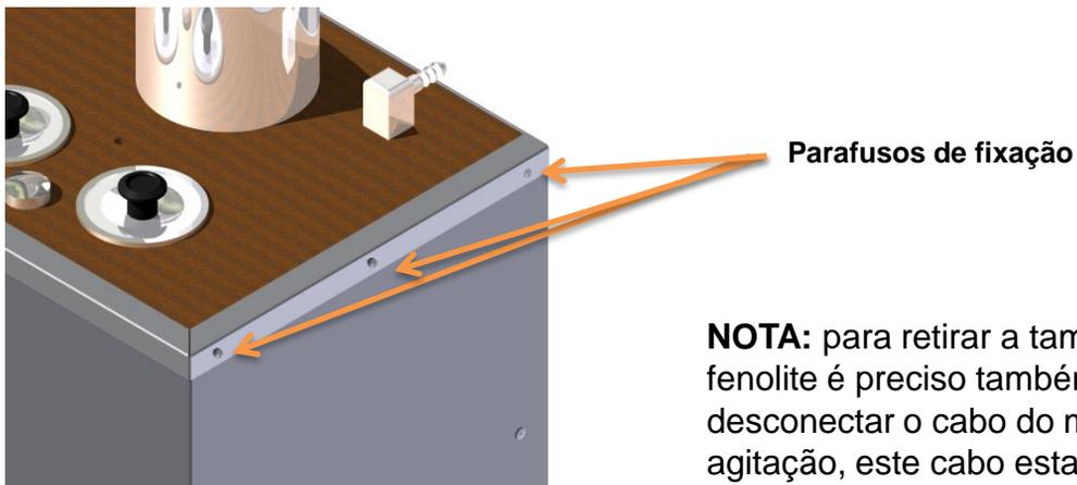
**NOTA:** para retirar a tampa de fenolite é preciso também desconectar o cabo do motor de agitação, este cabo está localizado na parte de trás do banho.
