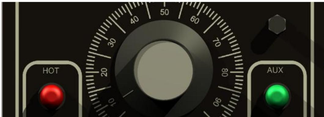
**7.2.3 NOTA.** Se o regulador de potencia estiver em 0% e a luz (HOT) estiver com intensidade máxima, e não houver aquecimento, isso indica um rompimento da resistência.
