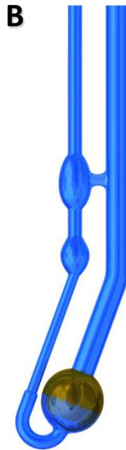
Uma vez cheio o capilar com a amostra, deixe-o estabilizar com a temperatura do banho por no mínimo 15 minutos, só então depois desse tempo faça a sucção para os dois bulbos menores, a amostra deve ultrapassar os dois meniscos como mostra em **C**.
