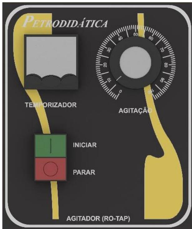
Quando pressionado INICIAR, o temporizador será iniciado ajuste o dial de 0 a 100% para aumentar ou diminuir a agitação.
